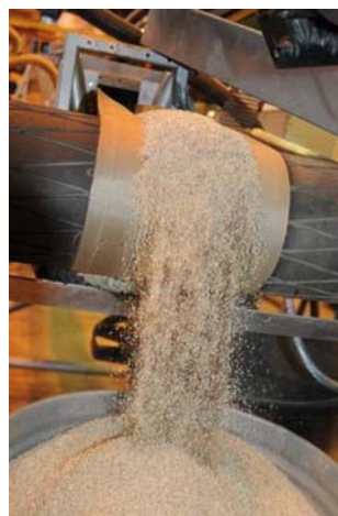
Микроволновое нагревание вермикулита в проточном режиме и расфасовка его в мешки
